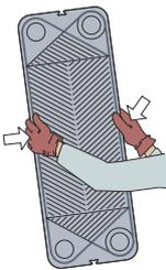
Abra el conjunto de placas deslizando la placa de presión por la barra sustentadora.
